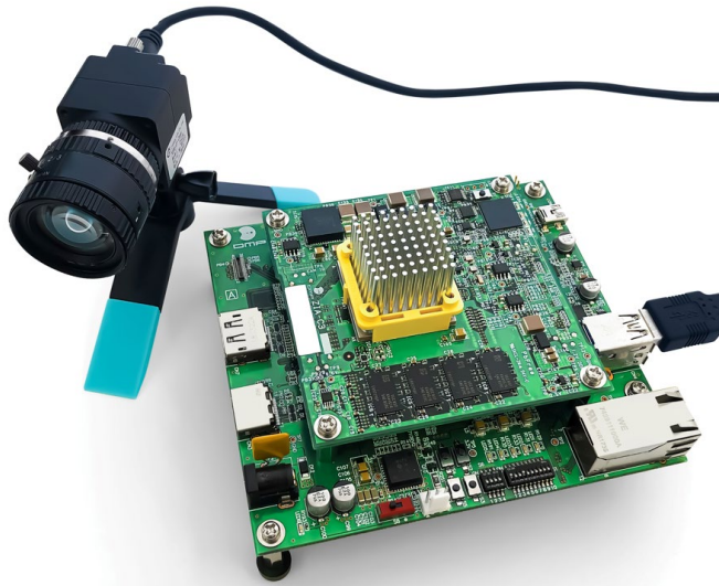
写真1) ZIA™ C3 と Prophesee イベントベースセンサー搭載カメラ外観
