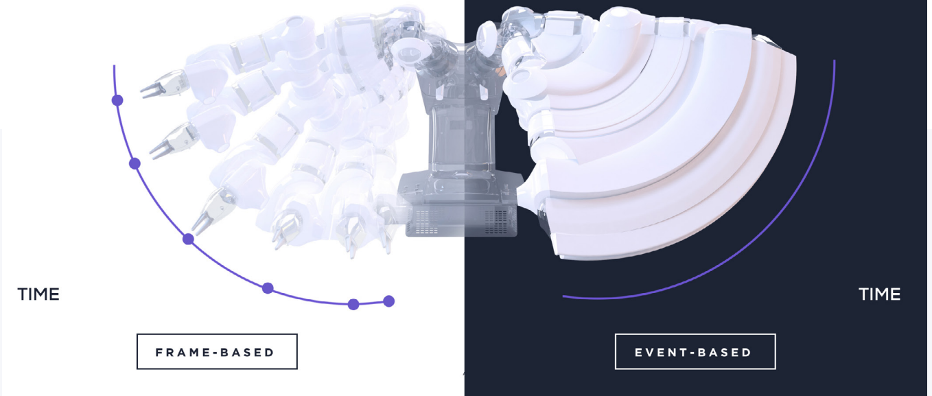
普诺飞思传感器将旋转的机械臂记录为连续的时空事件流
